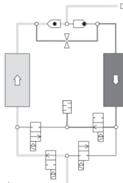
In questa figura, la rigenerazione avviene nel serbatoio di destra
